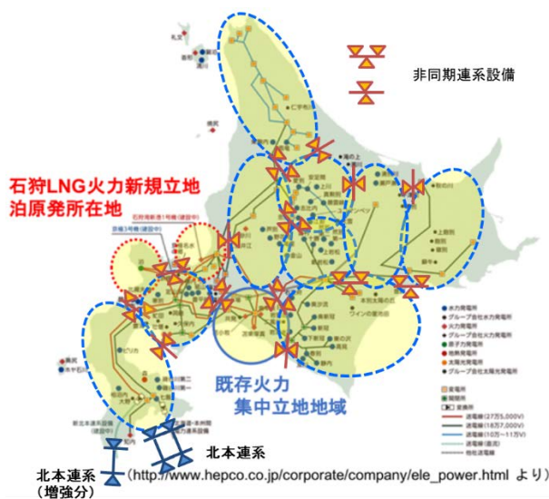
図4 中規模自律分散非同期電力系統（セル）の例
